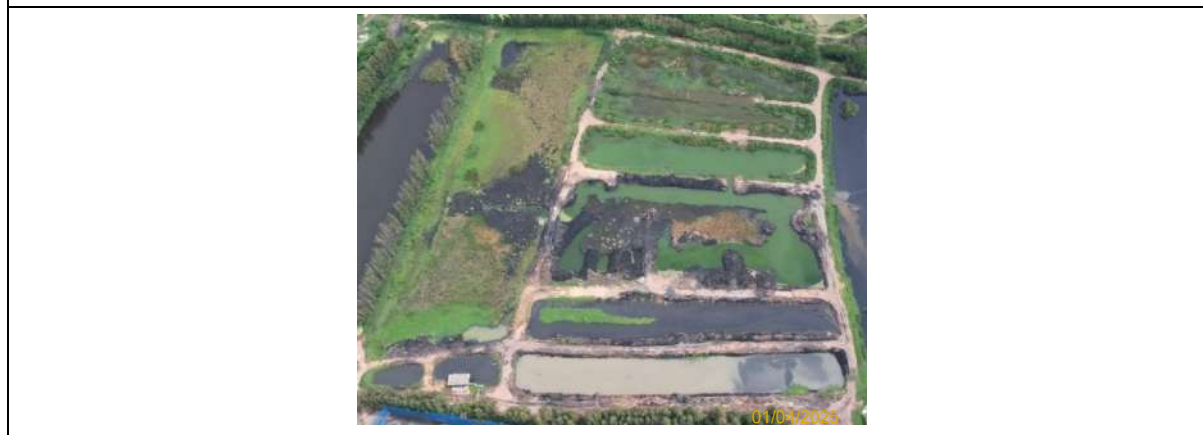
รูปที่ 2-9 ระบบบำบัดน้ำเสียของโครงการ ขนาด 1,800 ลูกบาศก์เมตร/วัน
